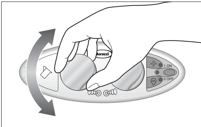
Во втором случае регулировка выполняется поворотом форсунки против часовой стрелки для увеличения (+) и по часовой стрелке для уменьшения или же полного закрытия.
